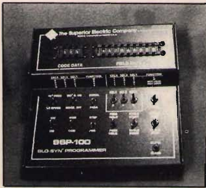
Figura 5. Semplice centralina di controllo per motore passo-passo.
